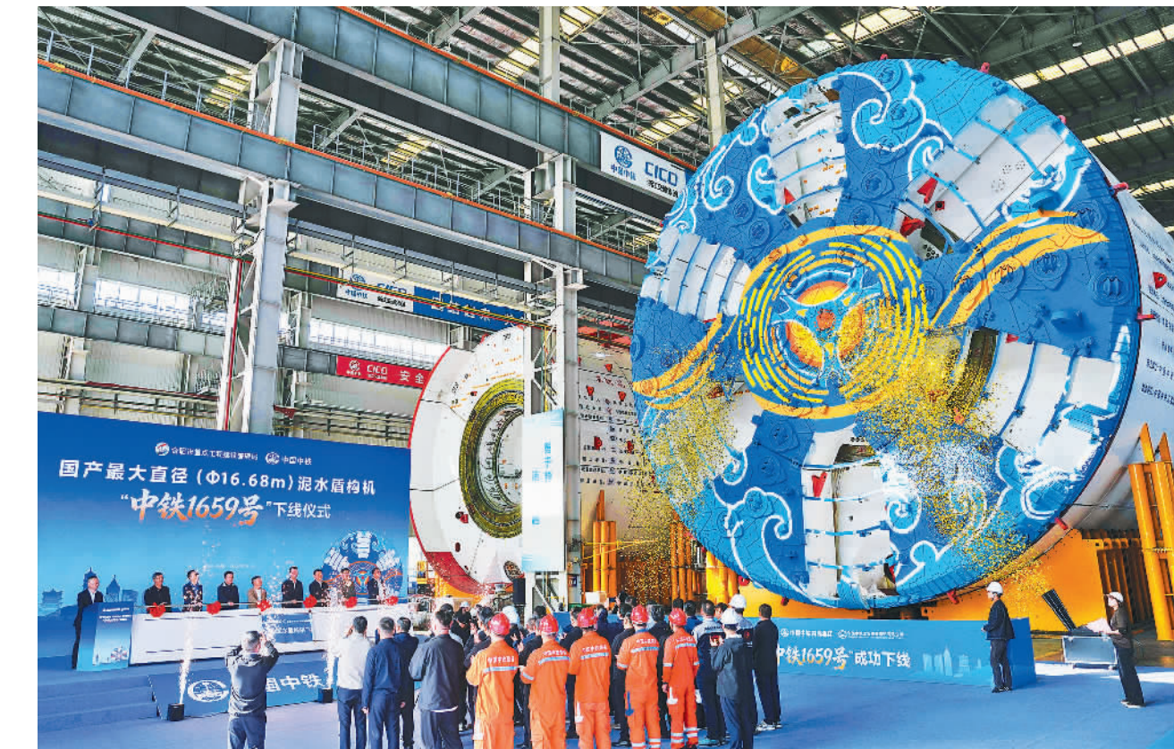
10月22日，由中铁四局联合中铁隧道局、中铁装备共同研制的超大直径泥水平衡盾构机“中铁1659号”在浙江杭州完成总装下线，即将投入安徽合肥G4001连接线1标(北二环西延)项目建设。“中铁1659号”开挖直径16.68米，整机长度约125米，标志着我国超大直径泥水盾构装备实现关键技术突破。 新华社记者 黄宗治摄
