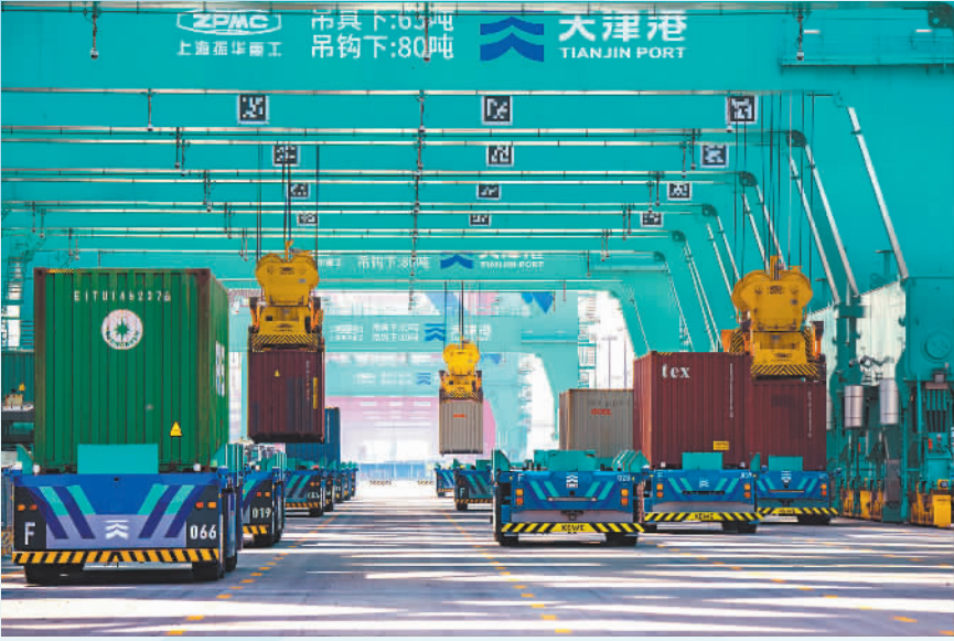
▲9月7日,天津港北疆港区智能化集装箱码头,人工智能运输机器人有序穿梭。 ▲5月20日,夜幕下的天津港,自动化码头一派繁忙景象。
