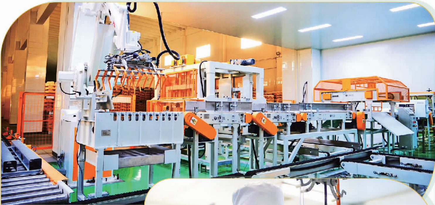
玉锋实业集团糊精车间内的包装机抓手和自动入库输送线。孙亚伟摄(中经视觉)
