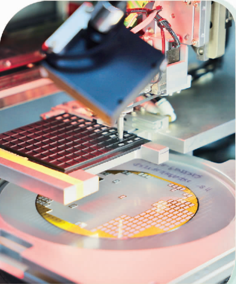
新佳电子生产车间内,机器正在自动分档取芯。(资料图片)
