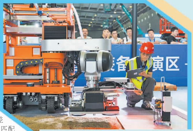
在2026长沙国际绿色智能建造与建筑工业化博览会上，技术人员操作机器人演示瓷砖铺贴。新华社记者 陈思汗摄
