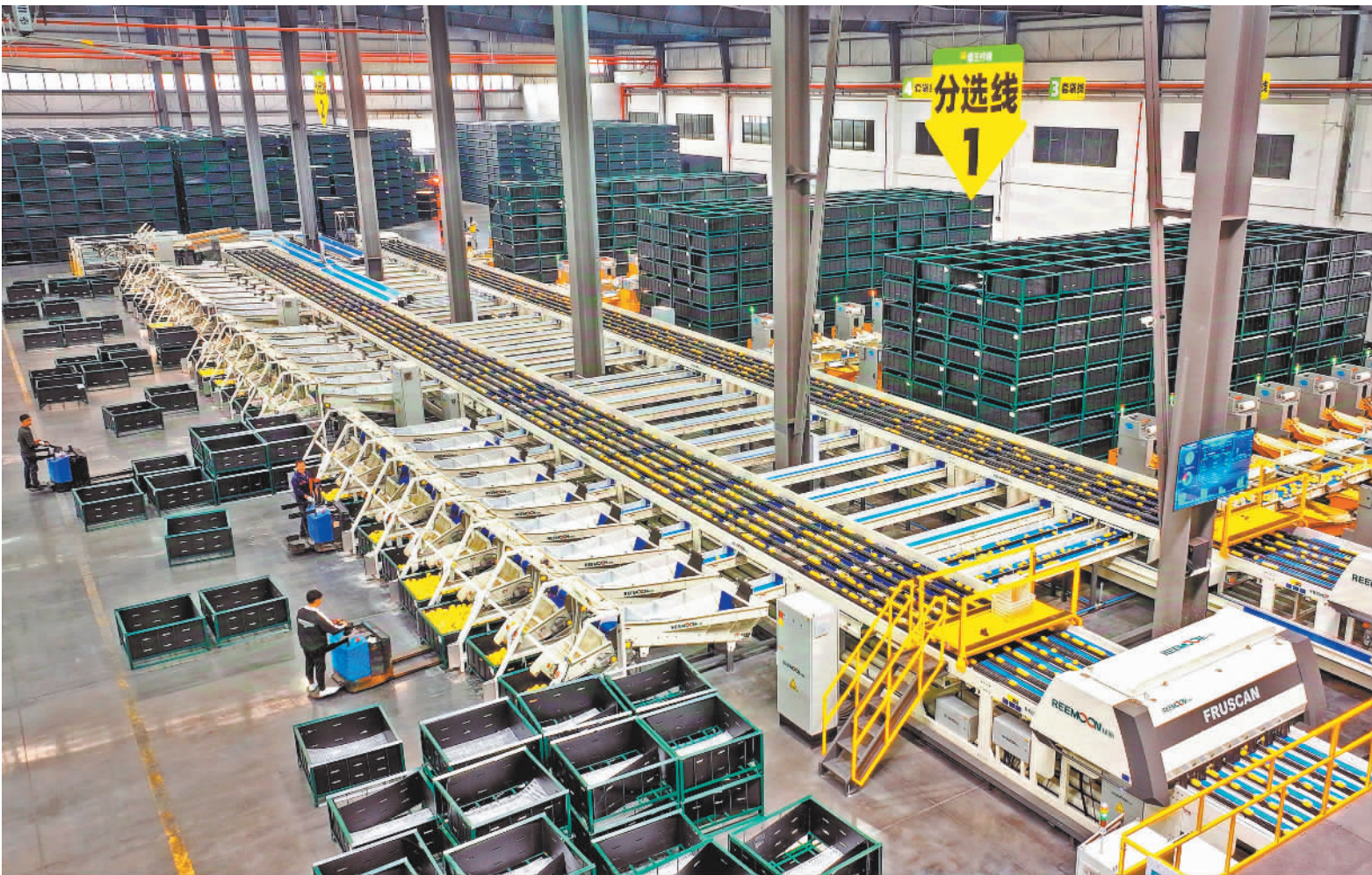
▲7月20日，位于潼南区的雪王农业(重庆)有限公司车间内，柠檬全自动分拣线有序运转，该企业可加工处理柠檬鲜果1200吨/天。 王浪摄(中经视觉)
