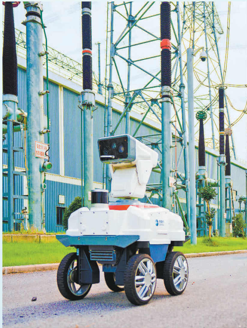
▲7月15日,国网上海超高压公司500千伏黄渡变电站,智能巡检机器人在巡视户外设备。 蒲映林摄(中经视觉)
