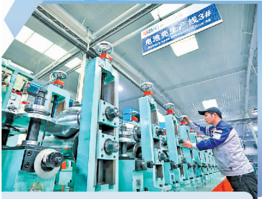
在新合源热传输科技有限公司生产车间，电池壳自动化生产线有序运转，技术人员在调试长芯电池壳体精密成型装备。
