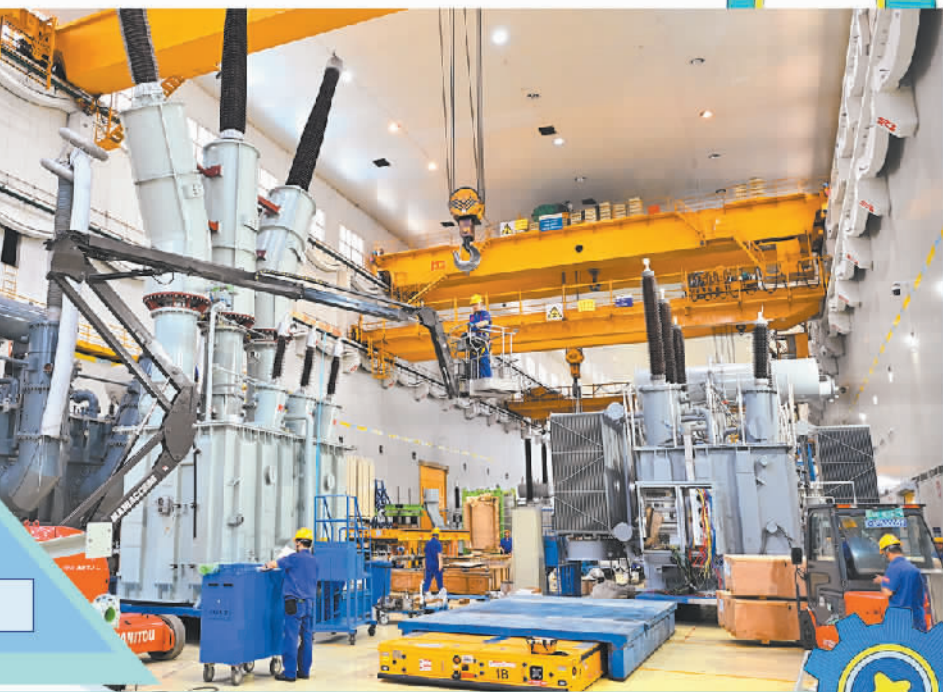
在保变电气总装车间,工人正在进行变压器装配作业。寇颖伦摄(中经视觉)
