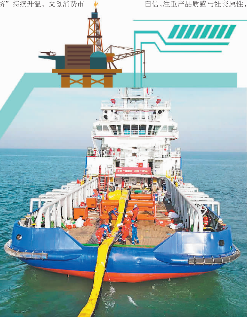
中海油能源发展股份有限公司安全环保分公司研制的防火围油栏在进行首次现场试验。 袁宇翔摄(中经视觉)
