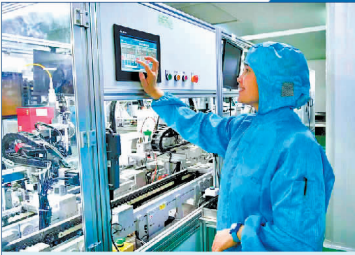
南昌工控电装有限公司生产车间内,技术人员在差压传感器自动产线上调整工位参数。 本报记者 刘 兴摄
