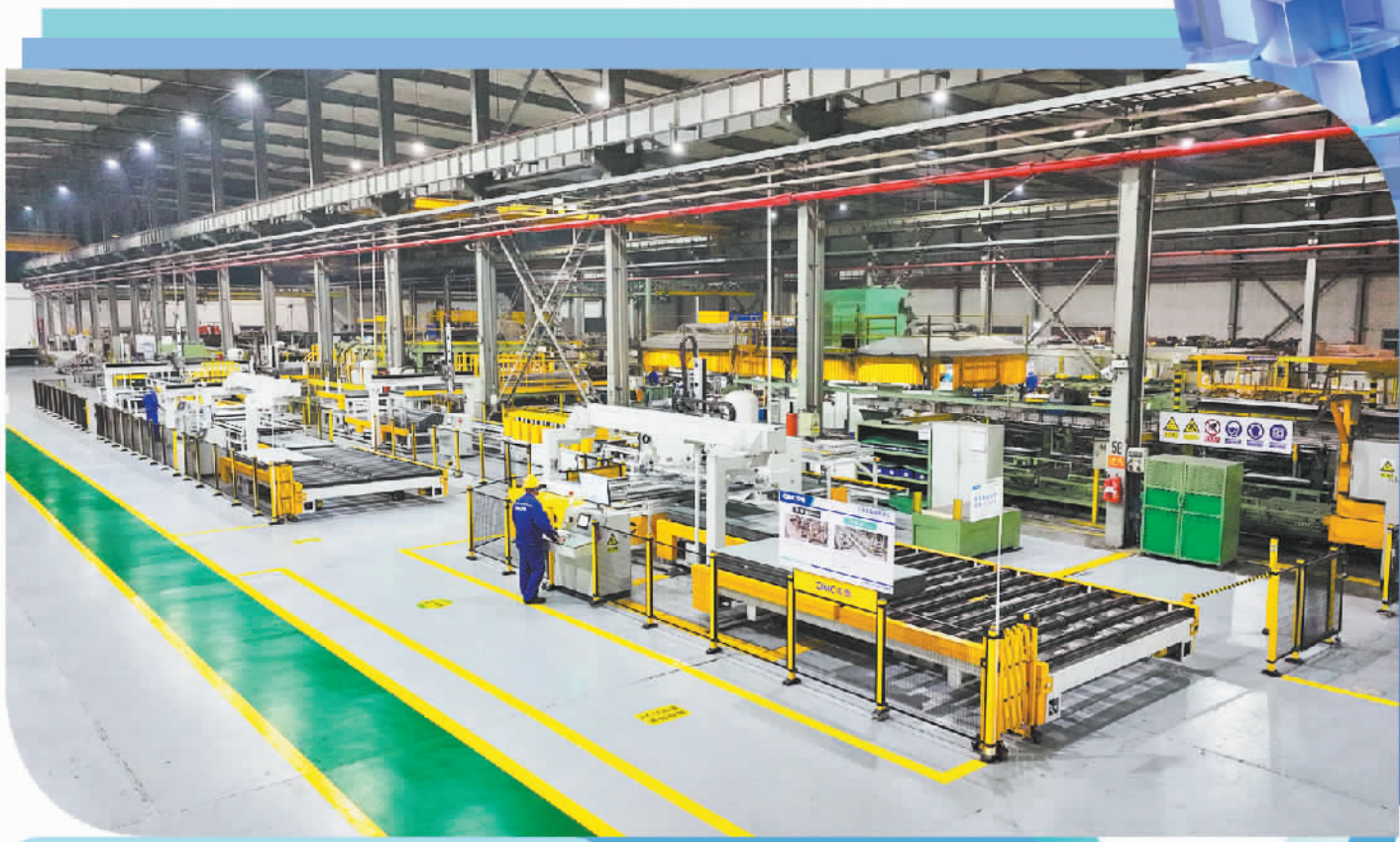
中集青岛冷箱公司门板筋智慧生产线。 刘心源摄（中经视觉）
