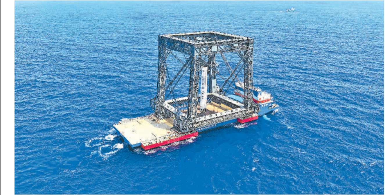
7月10日，长征十号乙运载火箭在海南商业航天发射场发射升空，成功将卫星送入预定轨道，火箭一级级成功回收。这是海上回收平台通过网捕方式成功回收长征十号乙运载火箭一子级。
