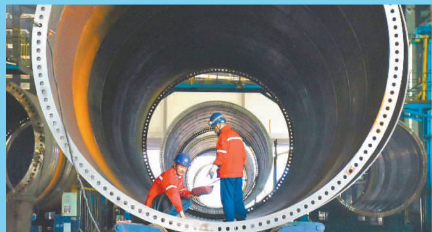
▲7月2日,白城市通榆县,天能重工有限公司员工在焊接风力发电塔筒。 赵 玉摄(中经视觉)
