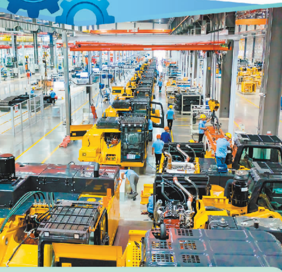
柳工挖掘机智慧工厂装配线。
