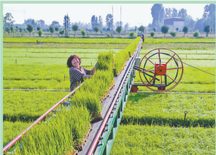
►5月31日，河南省信阳市光山县罗陈乡张楼村，农民用移动式水稻秧苗输送机在田间起秧苗。 谢万柏摄(中经视觉)
