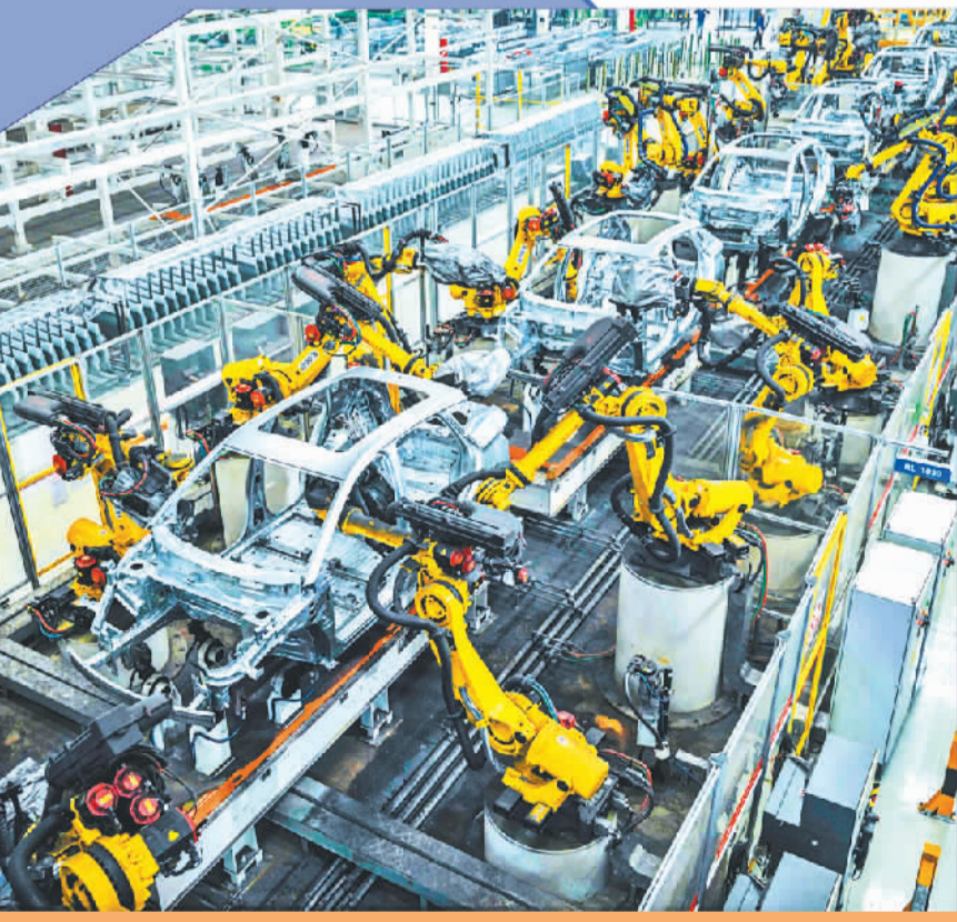
比亚迪常州基地生产车间内,机械手臂在对汽车车架进行焊接。
