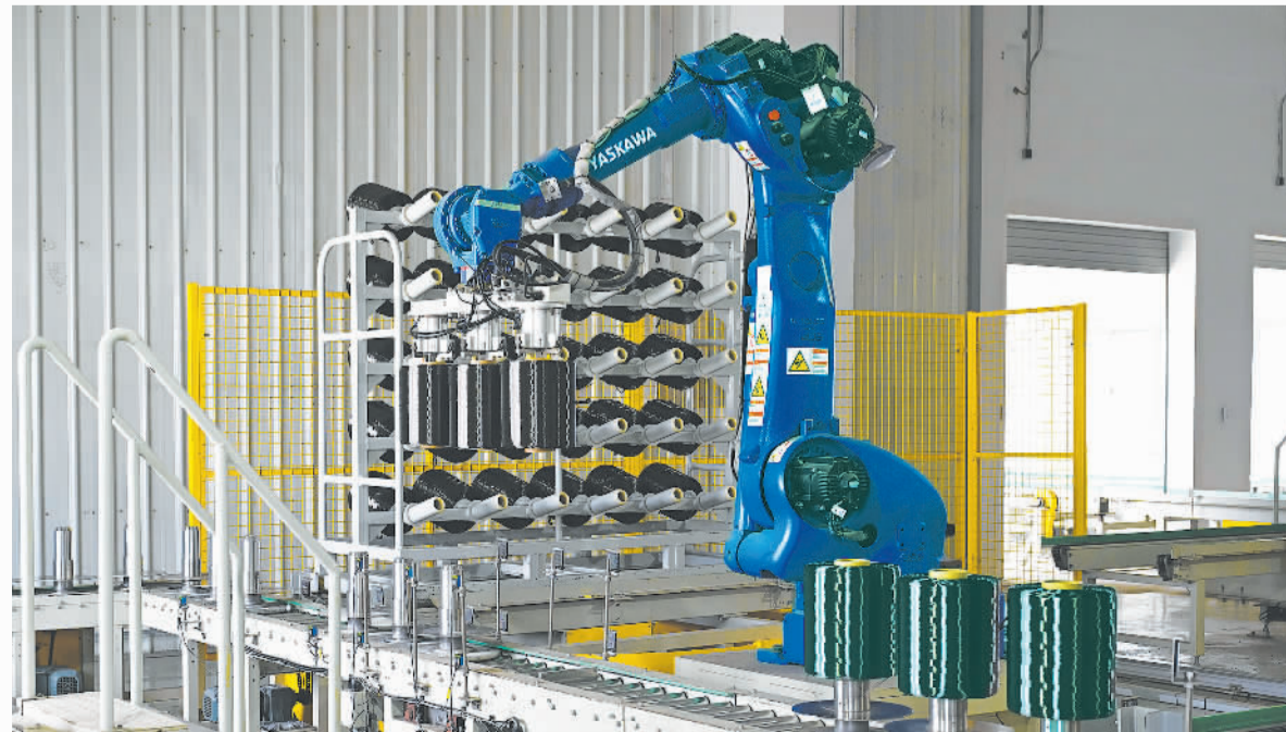
图为上海石化48K大丝束碳纤维包袋线。上海石化是我国首家掌握48K大丝束碳纤维产业化技术的企业，其核心技术是可以把48000根比头发丝还细的碳纤维原丝，同时从像“花洒”一样的喷丝板里喷出，且每一根粗细均匀，全程不能断丝。 新华社记者 陈浩明摄
