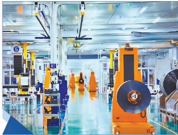
时代一汽生产车间CELL(电芯)生产线上,自动导引运输车正将物料自动转运至对应工序。(资料图片)
