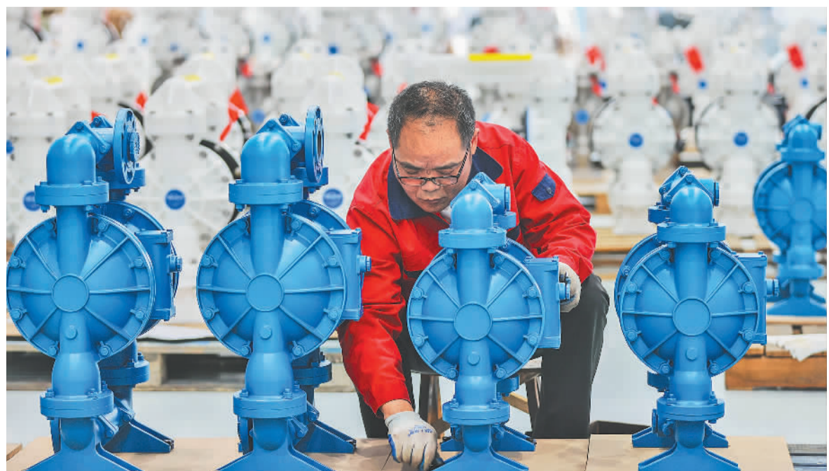
位于浙江省湖州市德清县的斯凯力流体科技(浙江)有限公司生产车间内,工人正专注生产调试隔膜泵。自成立以来,该公司作为全球知名的隔膜泵制造商,一直专注于流体输送,为各行业用户提供解决方案。 姚海翔摄(中经视觉)
