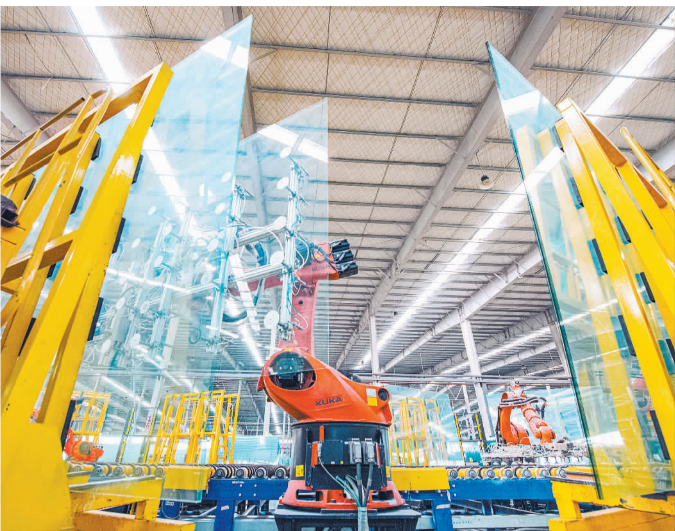
▲2025年11月12日,江苏省宿迁市宿豫区江苏苏华达新材料有限公司,浮法玻璃生产线机械手取片系统在自动堆垛玻璃。 徐江海摄(中经视觉)
