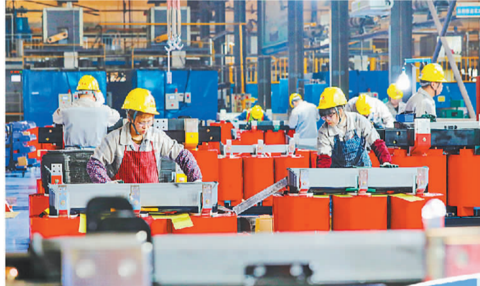
工人在江苏亚威变压器有限公司车间组装干式变压器。 顾彬斌摄(新华社发)
