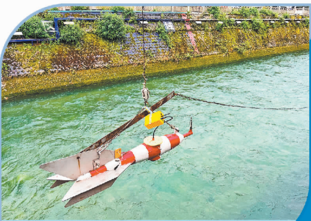
在四川省都江堰市水文化广场的测流点位，“量水秤”设施正在测验柏条河流速。(资料图片)
