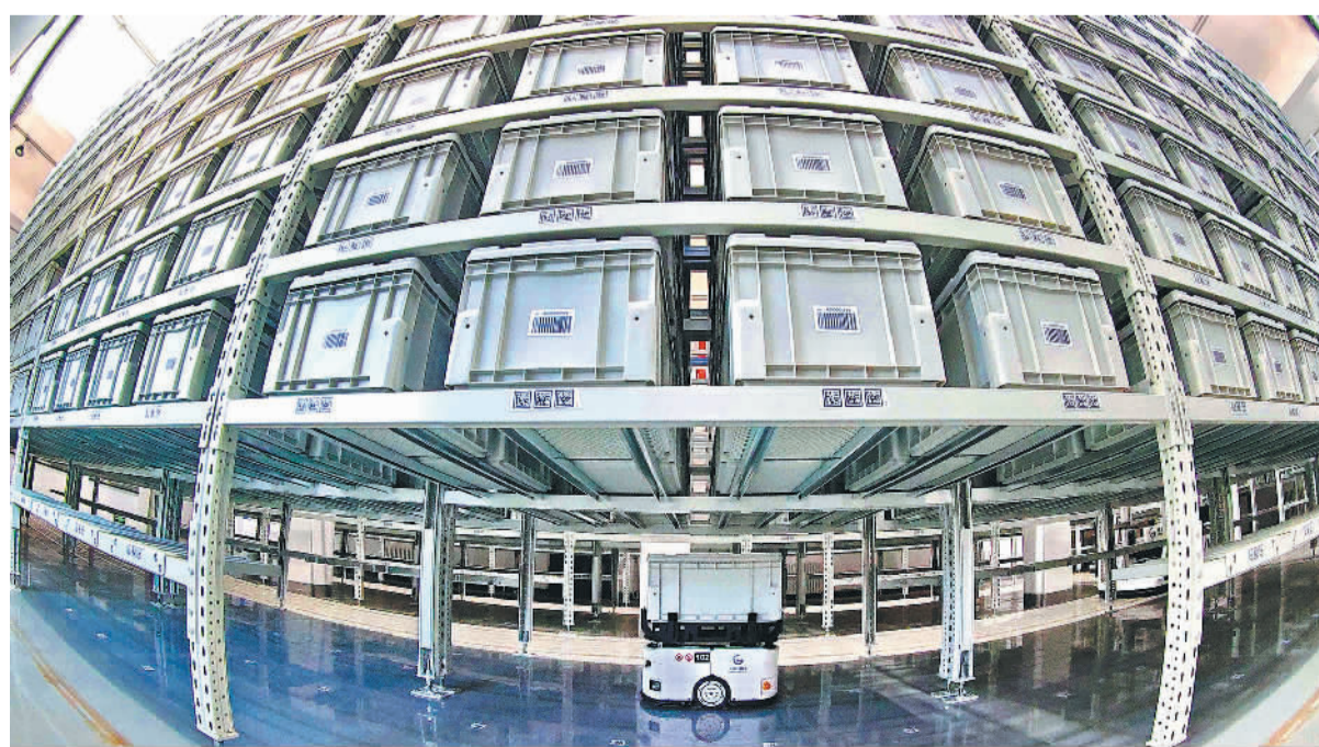
位于河北省秦皇岛市的河北港口集团河港物资秦皇岛中心仓内,机器人正在按照作业指令进行出入库作业。据了解,该机器人智能仓搭载机器人智能调度系统与定制化仓储管理系统,具备数据智能分析、货位自动分配、路径自主规划等功能。(中经视觉)
