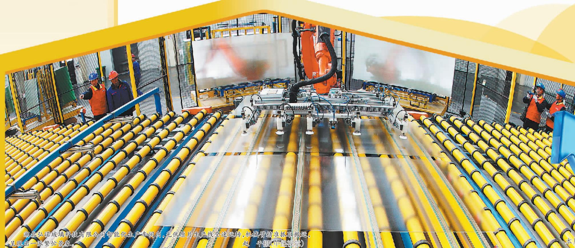
湖北弘诺玻璃科技有限公司智能化生产车间内，光伏原片生产线全速运转，机械臂精准抓取搬运，赵平摄（中经视觉）
