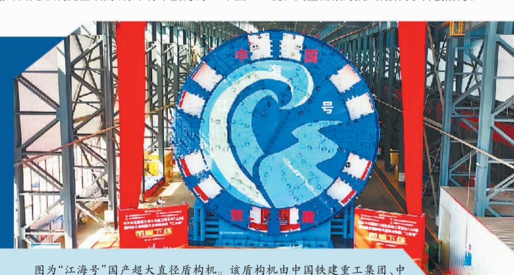
图为“江海号”国产超大直径盾构机。该盾构机由中国铁建重工集团、中铁十四局集团联合打造,最大开挖直径16.64米。汤叶摄(中经视觉)
