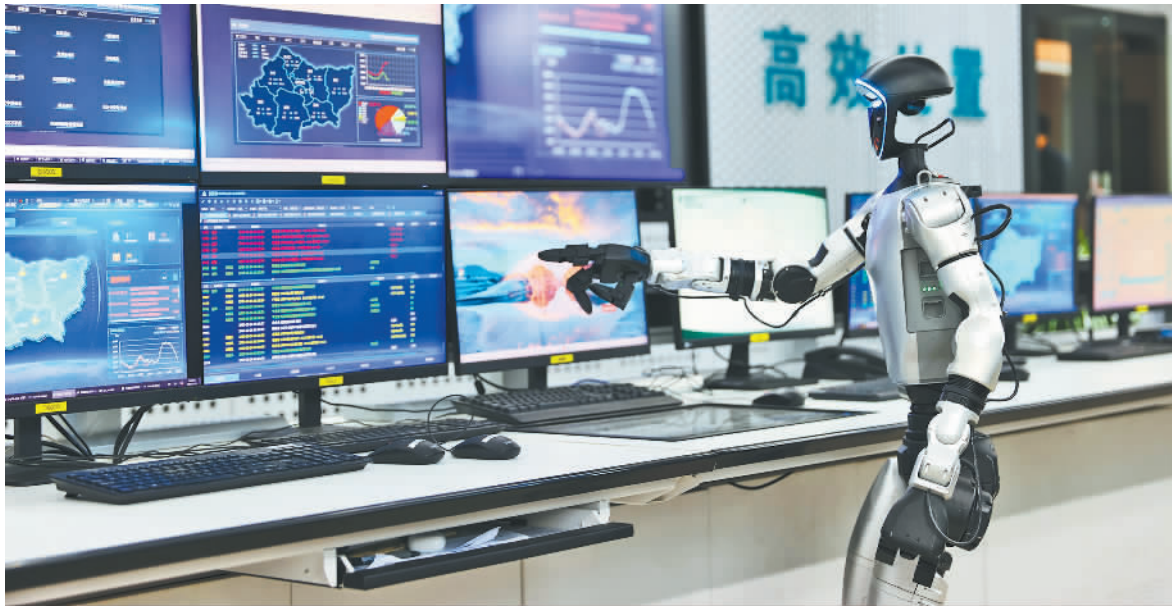
位于湖北省襄阳市的国网襄阳供电公司江北集控站监控大厅内,人形机器人专注“盯屏”。它能自动生成故障处置建议,遇到紧急情况还能自主拨打通知电话,让事故分析从15分钟缩短到秒级,故障处置准确率提升70%以上。
