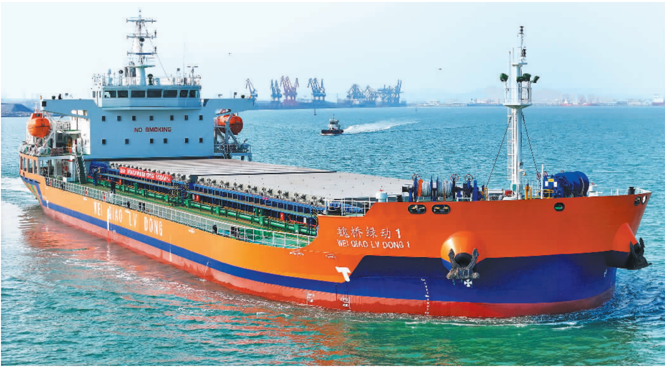
12月27日，我国首艘近海航区新能源散货船“魏桥绿动1”轮在山东港口烟台港投入运营。该船长109.8米，载重量近9000吨，采用并联油电混合驱动技术，最大纯电续航可达150海里，在进出港期间进行纯电驱动以实现港口和城市区域零排放。 唐克摄（中经视觉）
