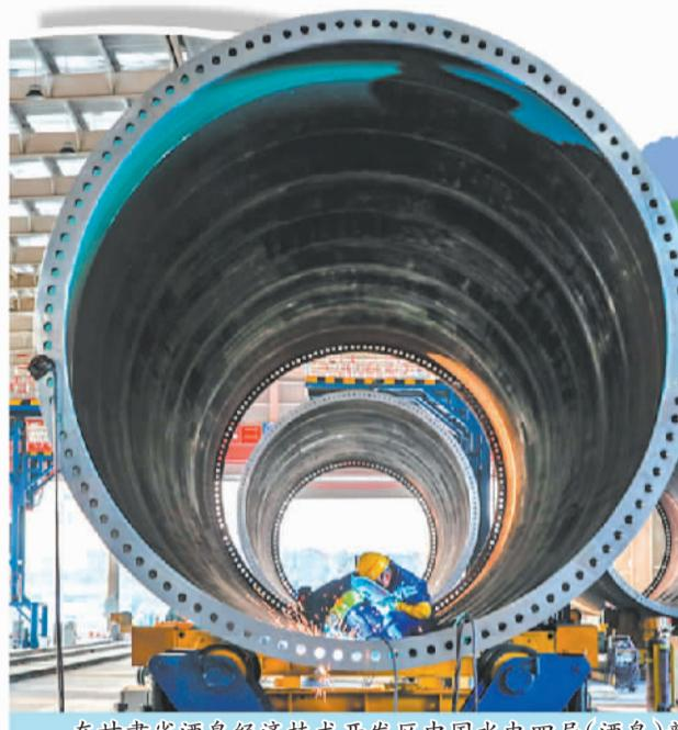
在甘肃省酒泉经济技术开发区中国水电四局(酒泉)新能源装备有限公司塔筒制造车间，工作人员进行风机塔筒焊接作业。
