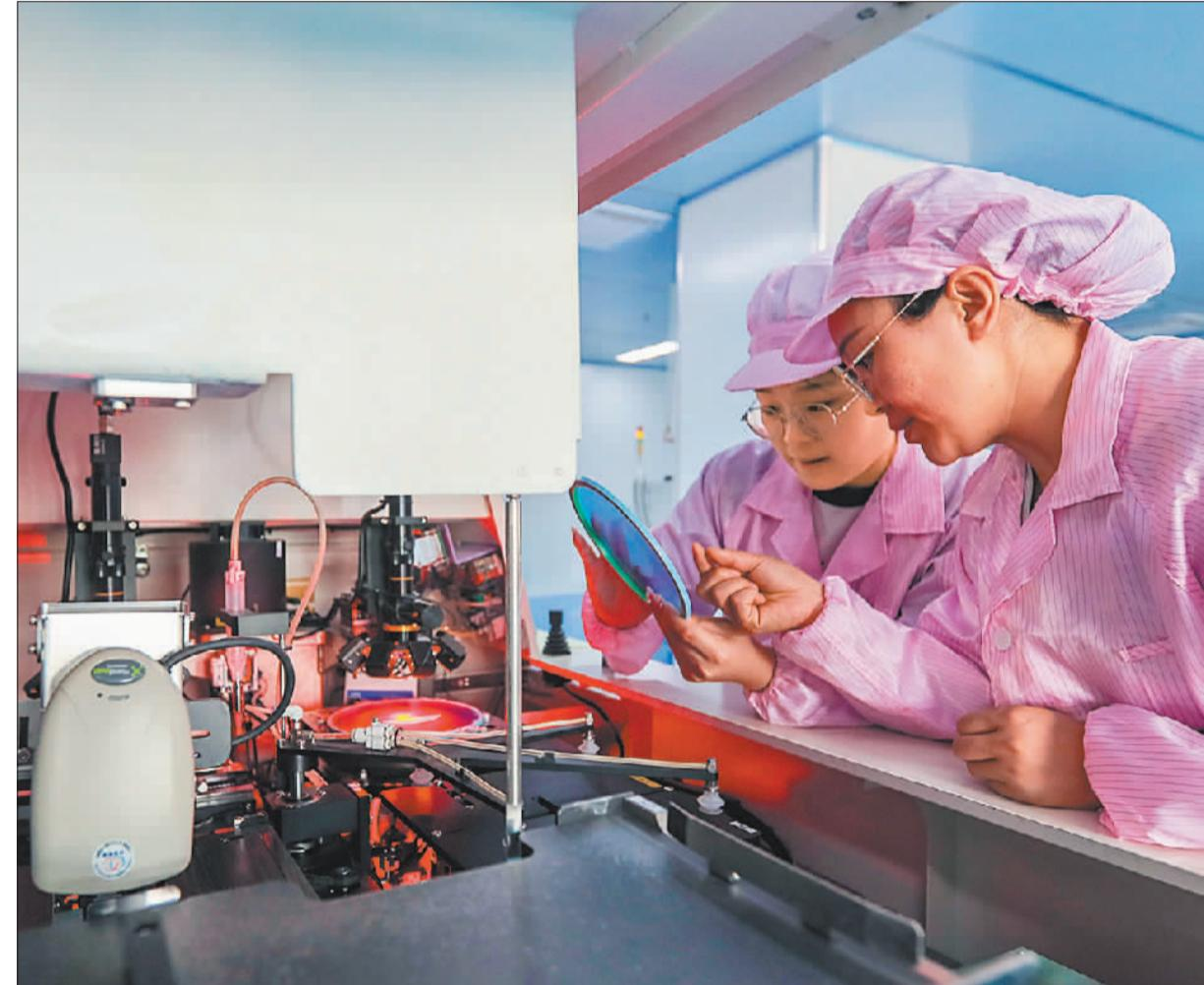
▼5月30日,位于运城经济技术开发区的山西西北铜新材料科技有限公司,工人在生产订单产品。该公司生产的“手撕铜”箔,厚度仅6微米,填补了国内该领域技术空白。
