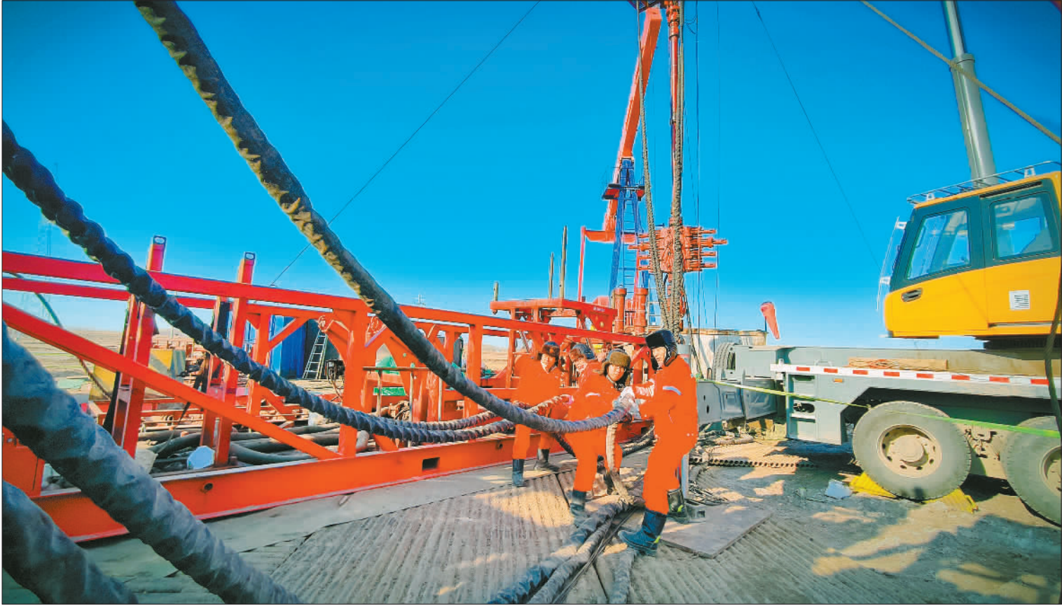
◀11月18日,大庆古龙陆相页岩油国家级示范区古页8H1扩大试验区,员工在进行连续油管冲砂作业。 许书晨摄(中经视觉) ▼11月18日拍摄的大庆油田页岩油勘探开发指挥部古页2号试验站。大庆油田2021年启动古龙陆相页岩油国家级示范区建设,实现油层效益开发。 许书晨摄(中经视觉)
