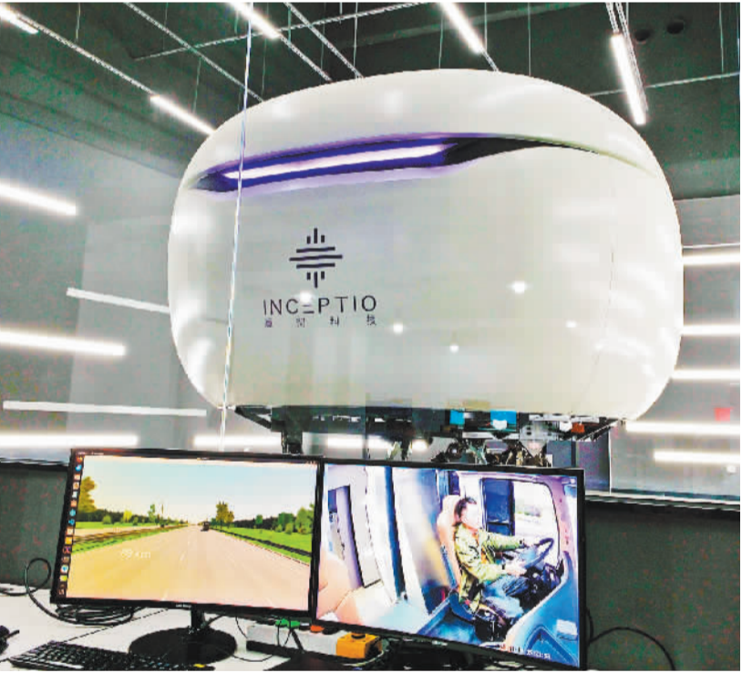
▲11月10日，赢彻科技DIL实验室，工作人员进行货车高速自动驾驶模拟仿真测试。该公司聚焦重卡自动驾驶技术研发与运营，已实现干线物流智能重卡规模化商用。
