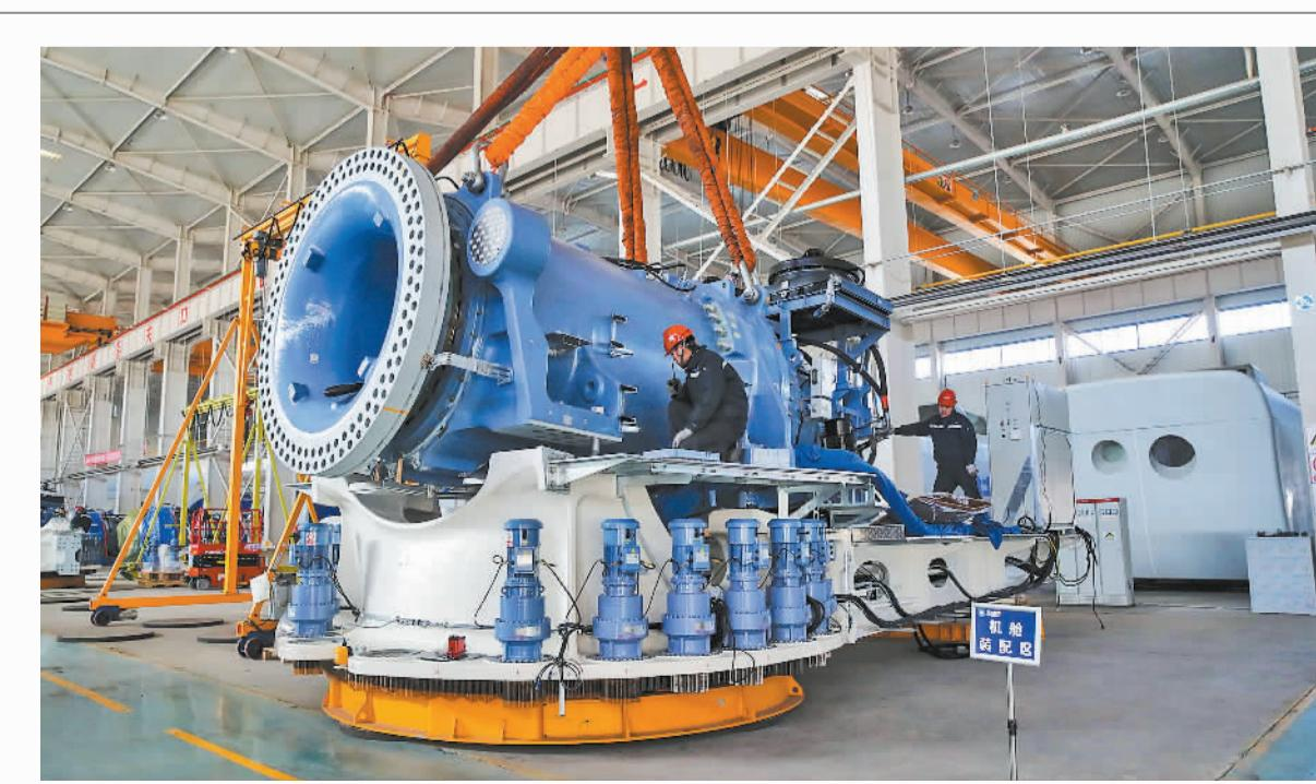
在甘肃省酒泉经济技术开发区的甘肃省云风智慧风电设备有限公司装配车间，工作人员进行传动链吊装作业。近年来，甘肃省酒泉市依托丰富的风能资源，持续推动形成风电全产业链发展格局。如今，当地风电装备整体实现本地化配套，现已具备年产2000万千瓦风电装备的综合能力。 新华社记者 邱兵摄
