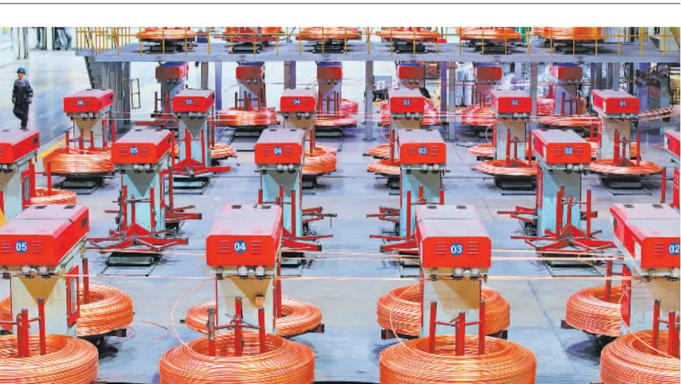
近日，位于江西省抚州市崇仁县高新技术园区的江西省恒翔电气有限公司智能化生产车间，在生产电磁线订单产品。近年来，该县通过延伸有色金属铜产品精深加工产业链，不断填补超高压电磁线生产空白，并运用“5G+工业互联网”模式赋能全产业链，实现了从传统制造基地向先进“智造”高地转换升级。 朱海鹏摄(中经视觉)
