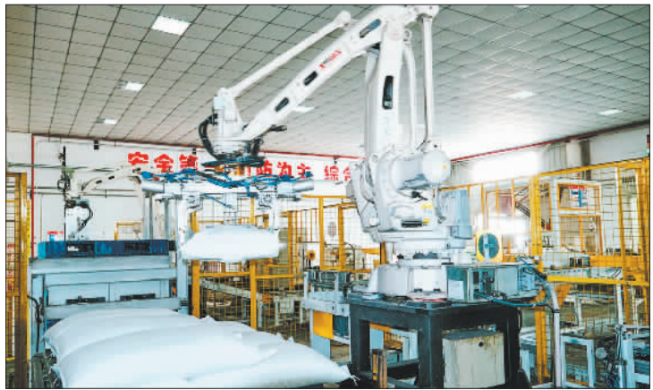
▼10月31日，佳木斯国家农高区中粮建三江米业有限公司内，自动机械手在抓取成品大米码垛。 纪世强摄(中经视觉)
