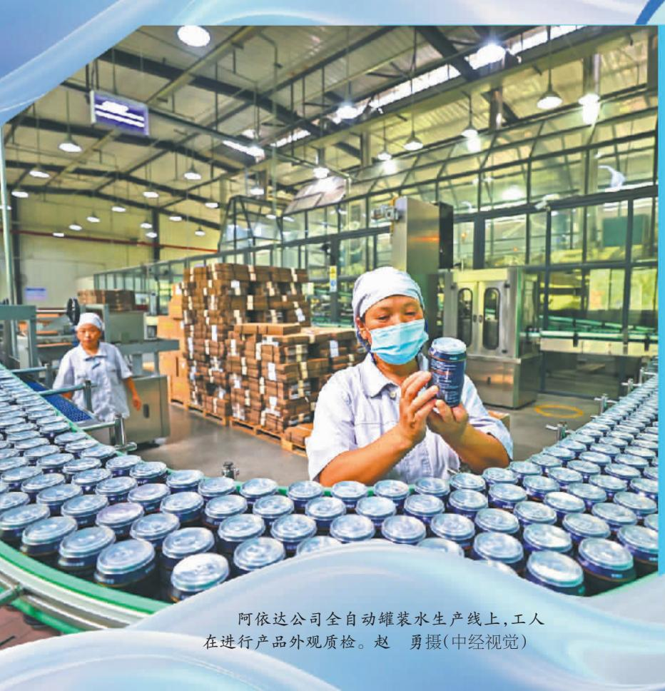
阿依达公司全自动罐装水生产线上,工人在进行产品外观质检。赵勇摄(中经视觉)
