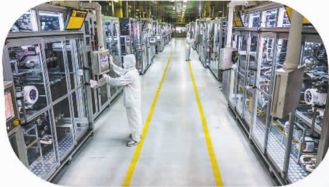
柳州国轩电池有限公司电芯生产叠片工序
