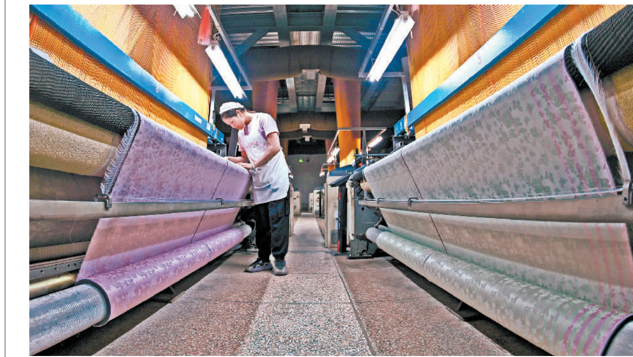
江苏海安市的海安县鑫缘丝绸有限公司织造车间内，纺织工人在操作智能提花机生产真丝坯绸。 顾华夏摄(中经视觉)
