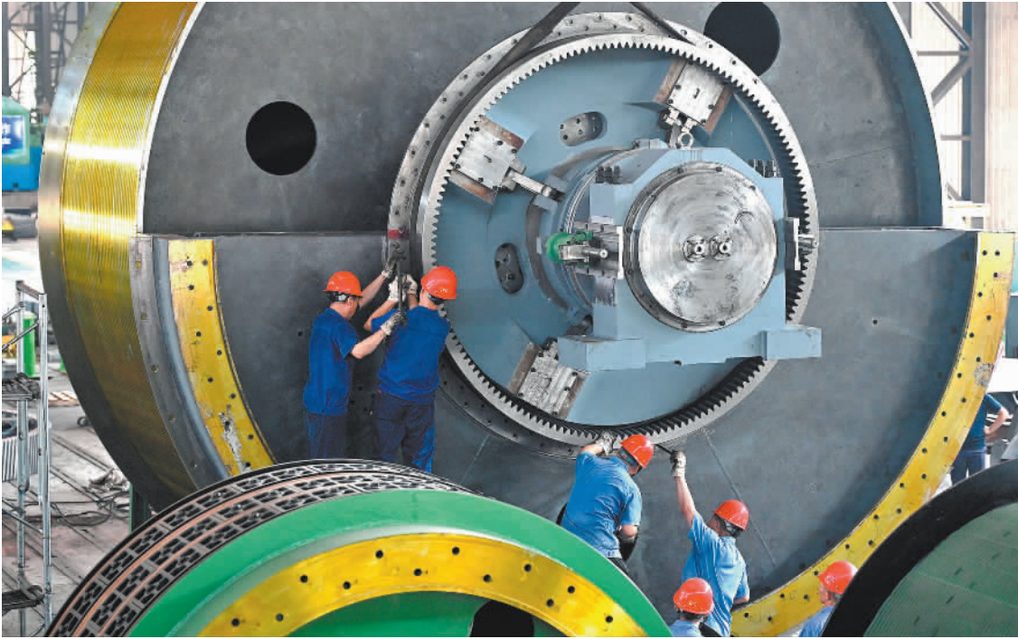
在河南省洛阳市的中实洛阳重型机械有限公司,工作人员在装配超大尺寸6米双筒可分离式提升机。张光耀摄(中经视觉)
