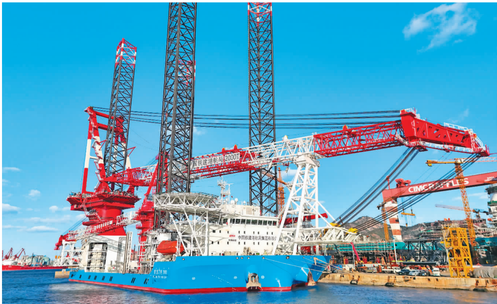
12月28日,第四代自升自航式风电安装船“铁建风电2000”,在中集来福士山东烟台建造基地交付。该船可在水深80米的海域进行20兆瓦以上各型海上风机的安装施工,满足了海上风电行业“深远海、大兆瓦”的趋势,实现了该领域“国船国造国用”的目标。
