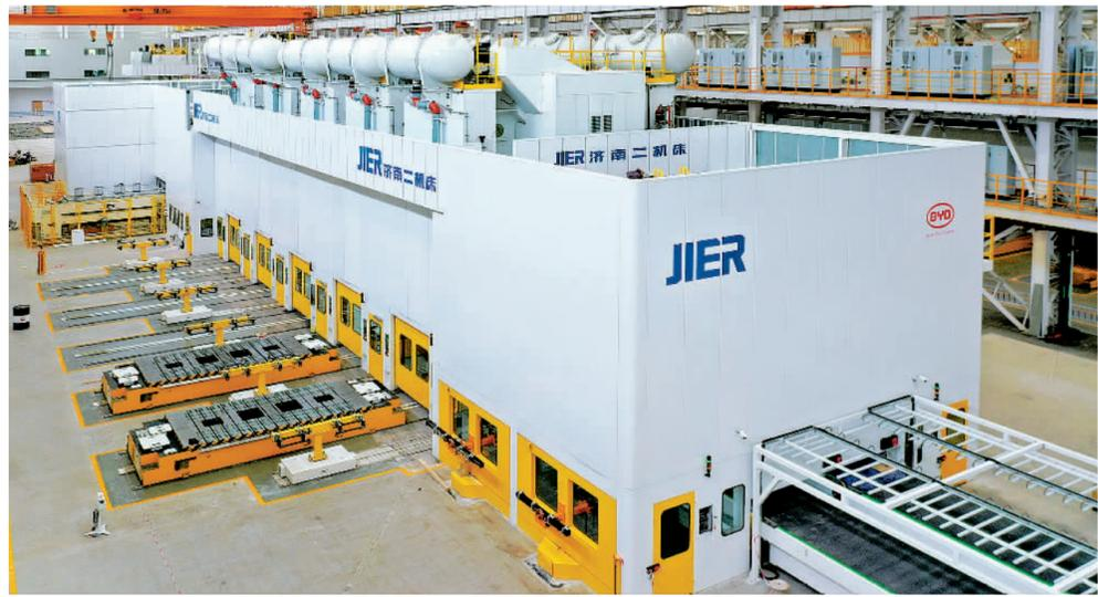
下图 济南二机床集团有限公司为比亚迪股份有限公司合肥工厂提供的大型冲压生产线，主要用于汽车外壳的生产制造，产品技术水平世界领先。（资料图片）
