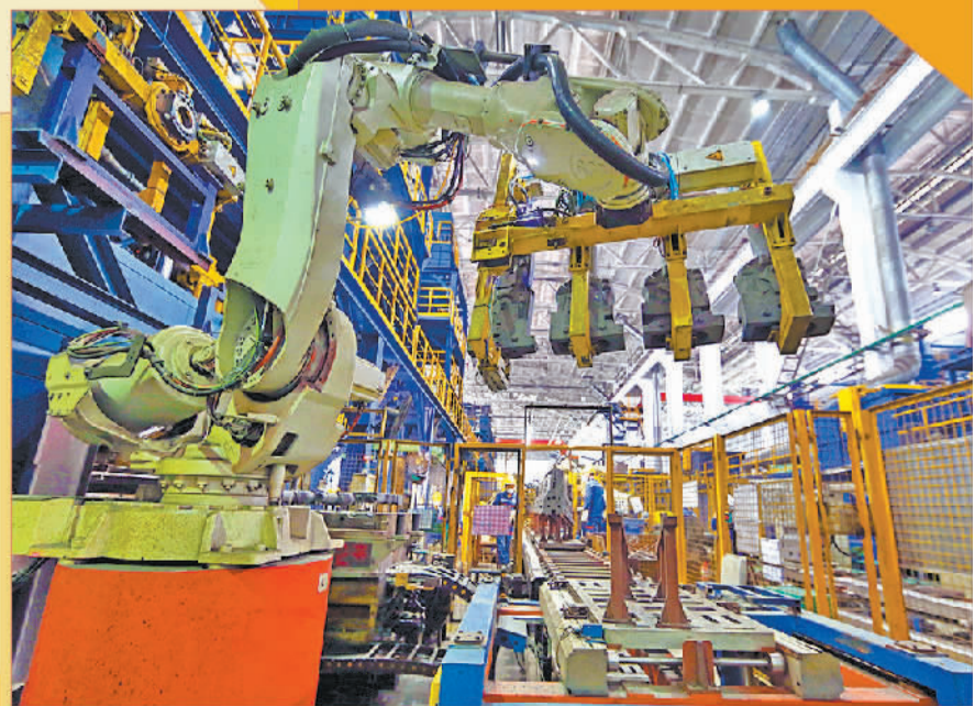
玉柴铸造公司生产线上，自动机器人在工作。
