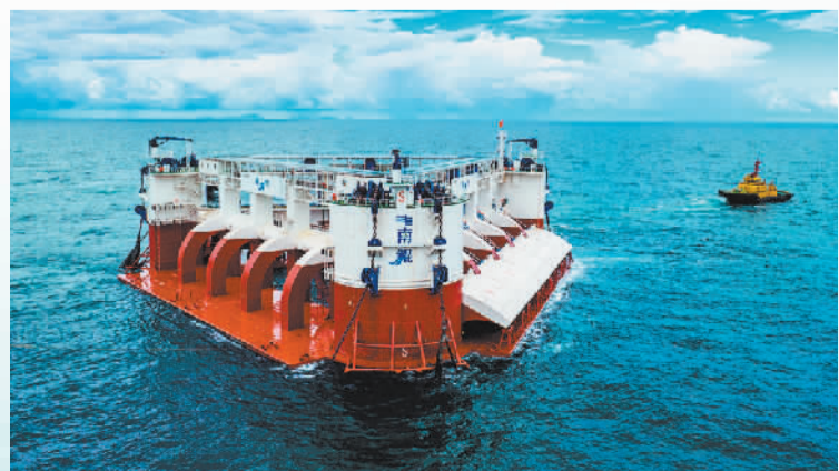
世界领先的兆瓦级漂浮式波浪能发电装置“南鲲”号,如同海上大型“充电宝”,每天可发电量相当于3500户家庭一天的用电量
