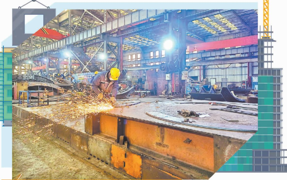
浙江广天构件集团生产基地内，工人在加工地铁钢砼管片相关组配件。俞妮娜摄(中经视觉)
