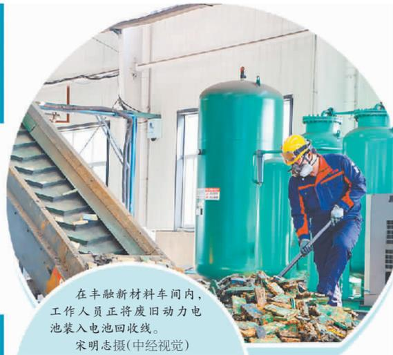
在丰融新材料车间内，工作人员正将废旧动力电池装入电池回收线。
