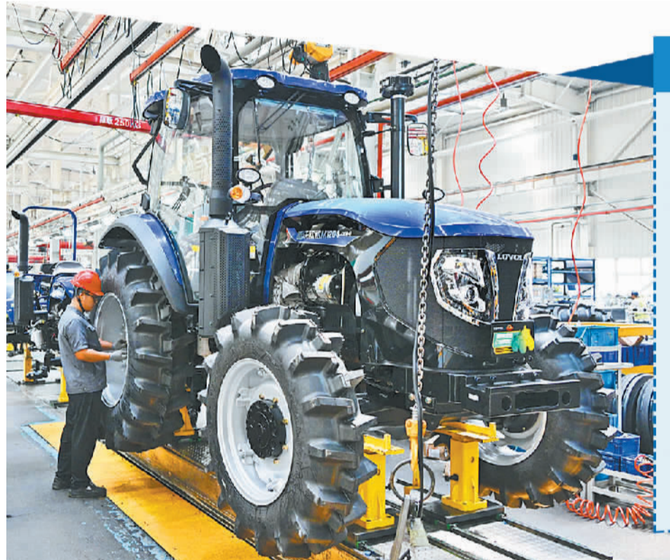
在潍柴雷沃智慧农业科技股份有限公司拖拉机工厂总装车间，工人在装配智能拖拉机。新华社记者 李紫恒摄
