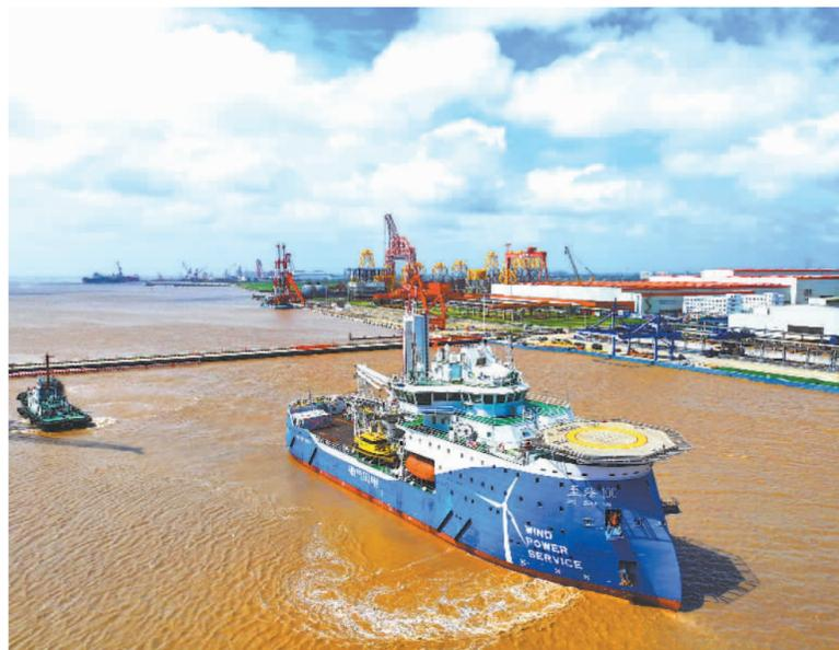
9月19日，上海振华重工为上海电气风电建造的亚洲首制风电运维母船“至臻100”“至诚60”在江苏启东启航投运，将服务江苏、广东两处风电场。两艘风电运维母船均可在深远海风场进行连续运维作业的专用高效船舶，集高效运维、绿色运维、智能运维、安全运维于一体，自持力均达30天以上。
