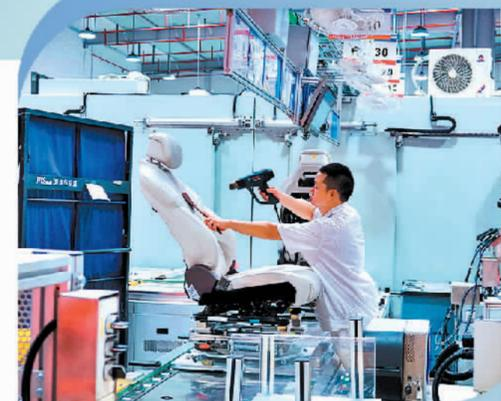
东风李尔汽车座椅生产车间内,工作人员在进行座椅烫整工作。
