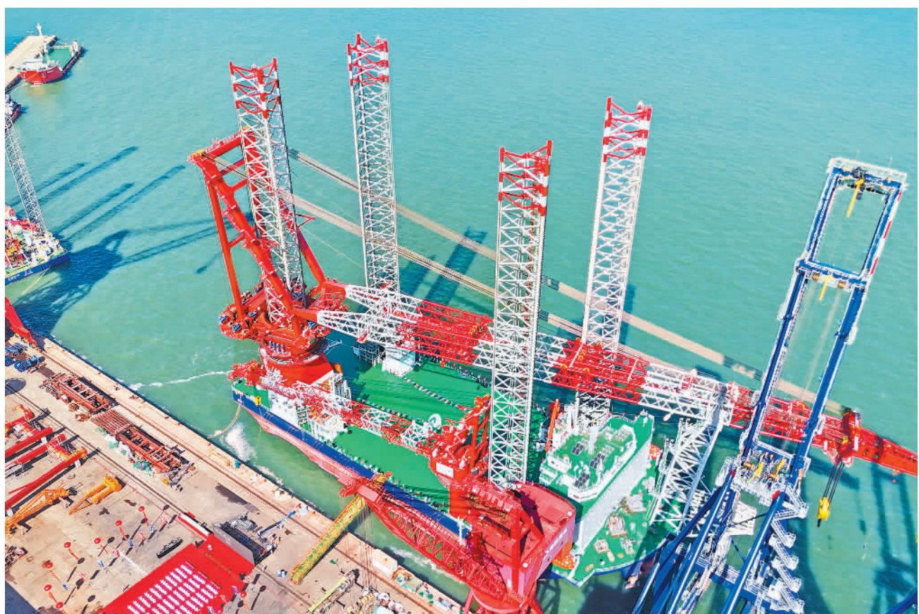
8月28日,搭载智能船舶系统的自升自航式海上风电安装平台“港航平5”,在中国船舶旗下的青岛海西重工有限责任公司举行交船仪式,正式交付业主天津港航工程有限公司。“港航平5”平台船长135米,宽50米,最大作业水深70米,最大起重能力1800吨,正式投用后,预计一年可安装海上风机100台以上。 张进刚摄(中经视觉)
