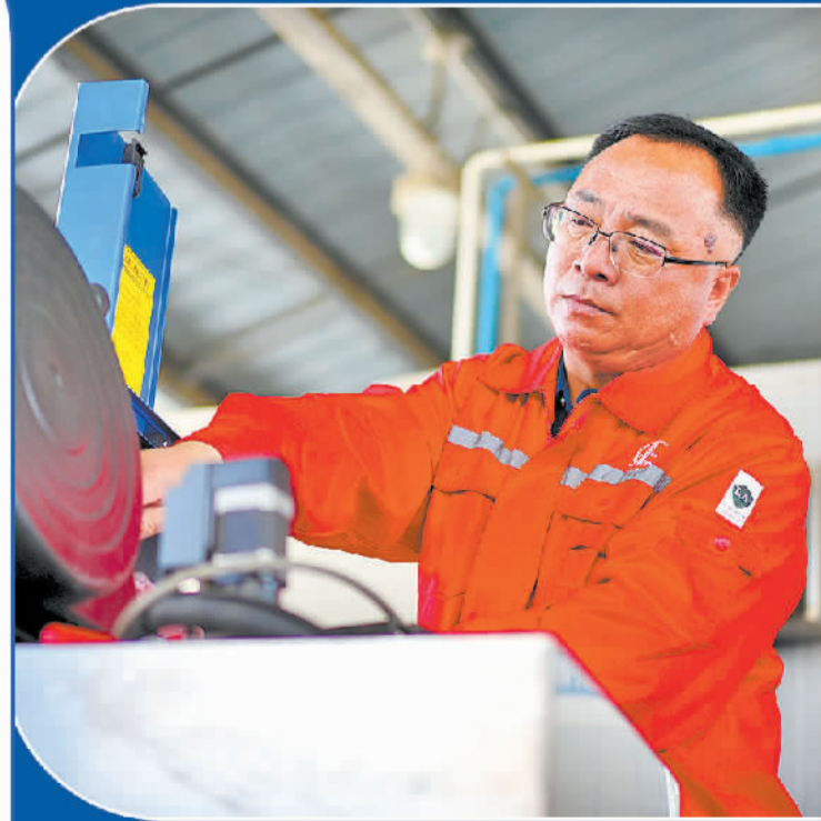
胜利油田地面工程维修中心现河维修服务部首席技师贾学志利用小口径金属管道自动焊装备进行焊接试验。(资料图片)
