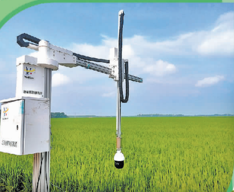
图为红卫农场示范区地块内用于监测水稻生长情况的智能水稻叶龄诊断仪。
